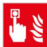
Déclencheur manuel d'alarme incendie
